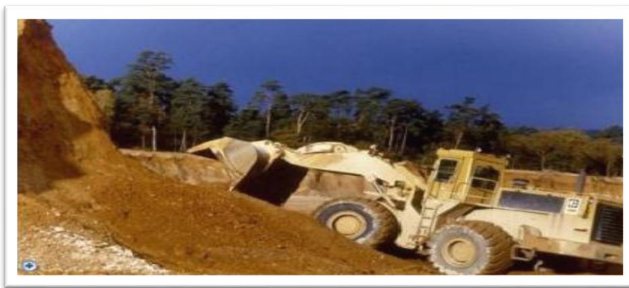
Figure II.3 : Exploitation de granulats alluvionnaire à la chargeuse en terrain sec.
